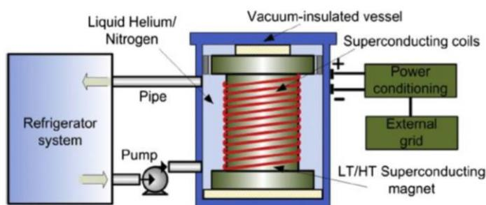
**Figura 12 - Diagrama esquemático de um sistema magnético de armazenamento de energia - SMES <sup>21</sup>.**
