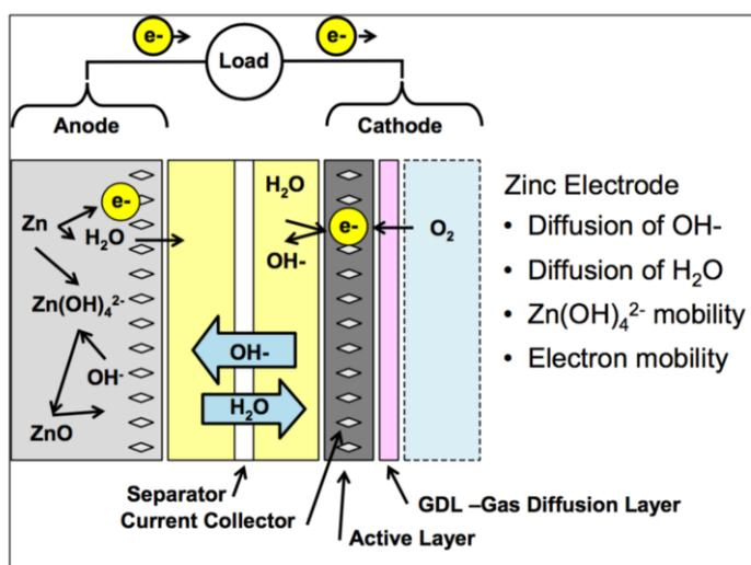
Figura 11 - Esquema construtivo de uma bateria Zn/ar
