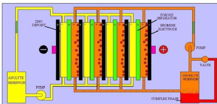
Figura 9 – Configuração esquemática de uma bateria ZNB<sup>10</sup>.
