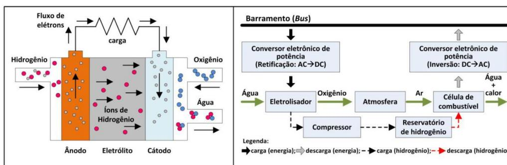
Figura 7 - Esquema básico de uma célula de combustível e diagrama de operação.
