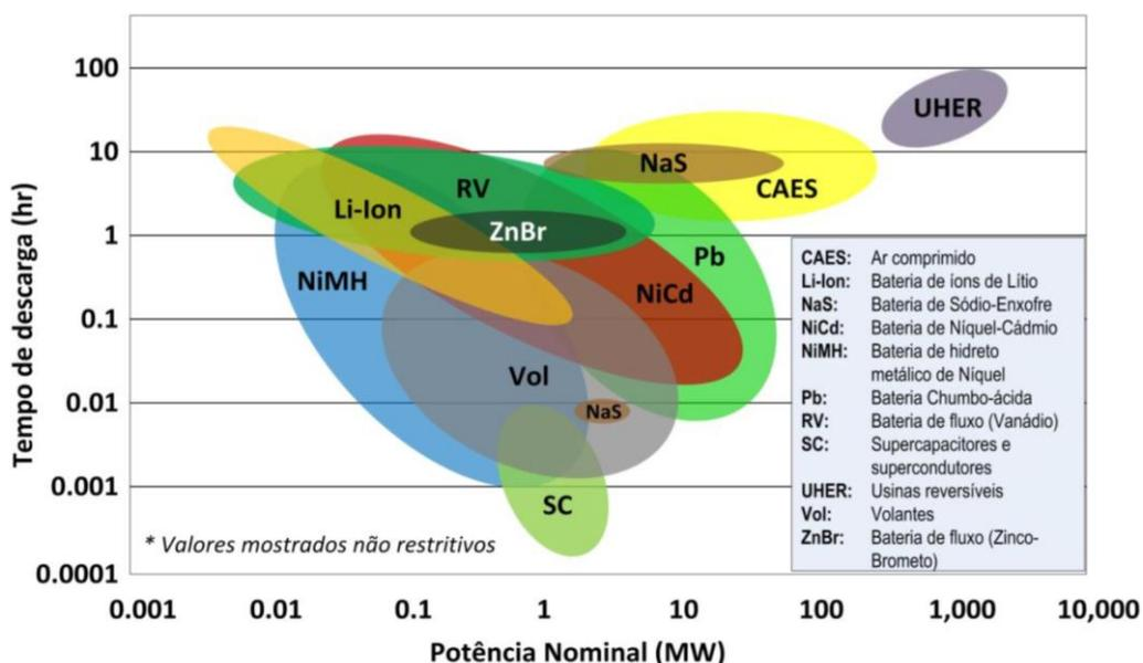
Figura 4 – Aplicações das tecnologias de armazenamento considerando a potência instalada (MW) e o tempo de descarga <sup>10</sup>.
