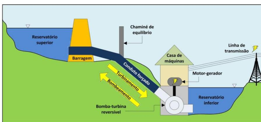
**Figura 5 - Esquema de uma usina hidrelétrica reversível<sup>12</sup>**
