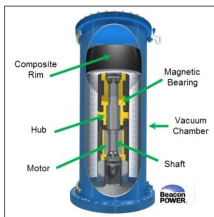
**Figura 6 – Ilustração de um sistema de armazenamento com tecnologia de volantes de inércia.**
