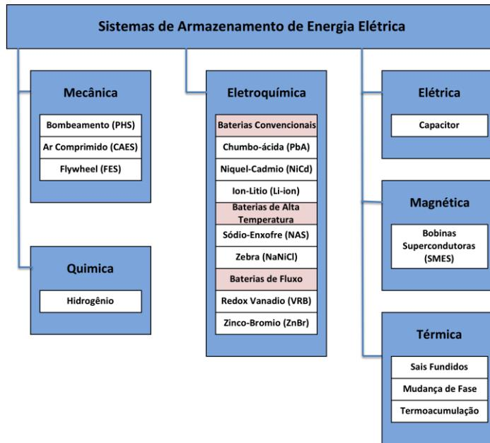
Figura 2 – Classificação dos sistemas de armazenamento de energia elétrica de acordo com a natureza do processo.
