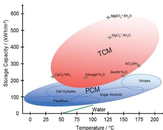
**Figura 13 - Campo de aplicação das tecnologias de armazenamento térmico <sup>25</sup>**
