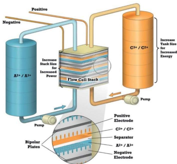
Figura 8 – Esquema de uma bateria de fluxo <sup>6</sup>
