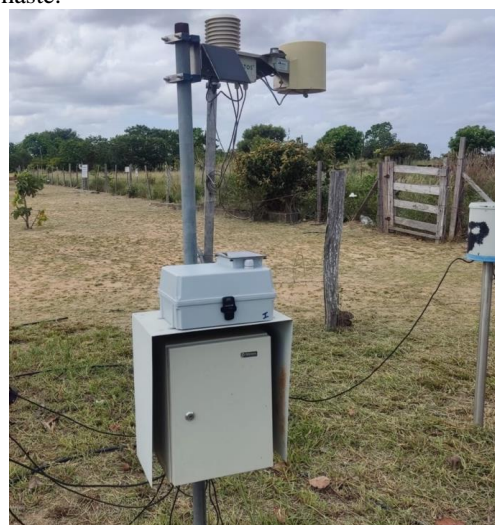
Figura 3 ó Sensores da estação de Cauamé (na haste) e o desenvolvido no projeto (abrigo cinza).
